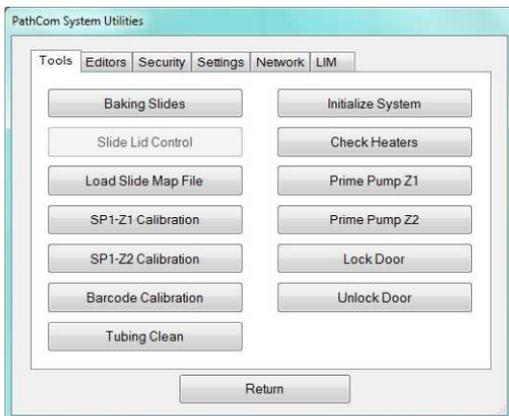
5. Die Sonden Z1 und Z2 saugen beide von ihren jeweiligen Rack-Positionen **5 ml** Reinigungslösung in die Leitungen an. Das System startet dann einen **20-minütigen Countdown**.
